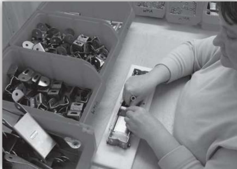
Eine Antennenhalterung montieren
